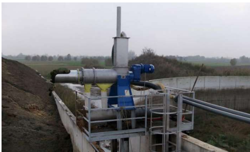
FIGURA 7.5 ESEMPIO DI SEPARATORE ELICOIDALE
